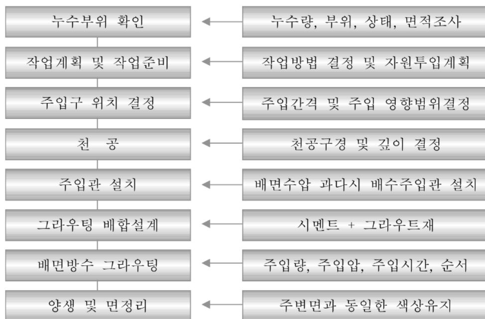
【그림 6.3.12】 배면주입방수 공법의 시공순서도
