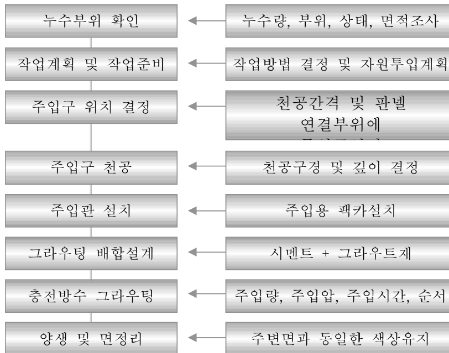
【그림 6.3.10】 충전주입방수 공법의 시공순서도
